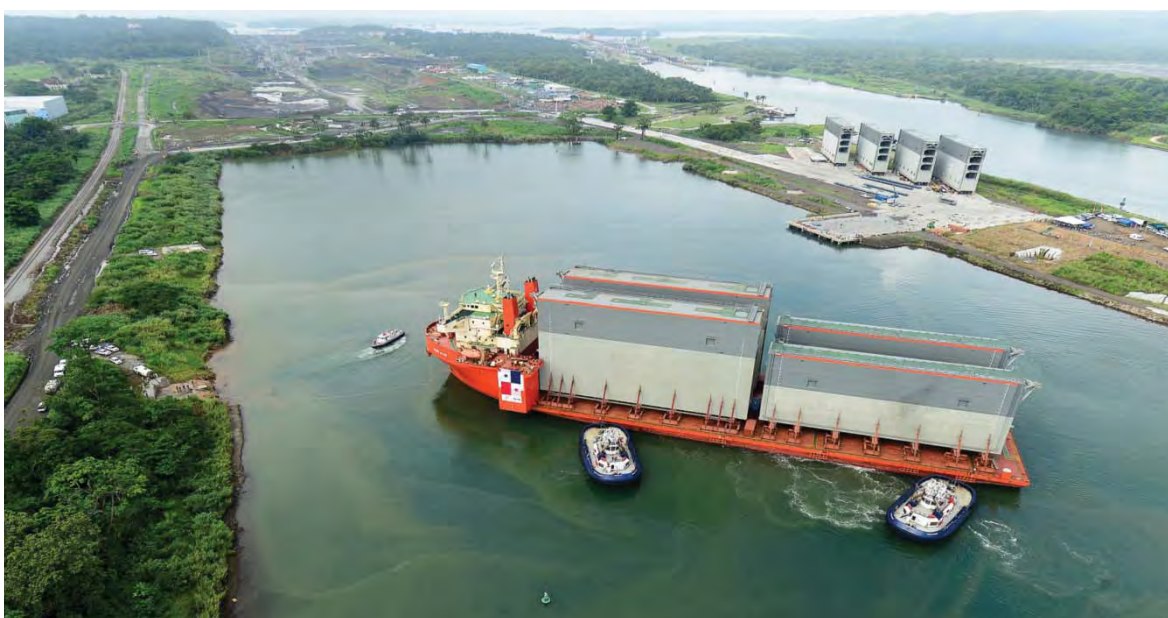
Přeprava deskových vrat pro nové plavební komory
