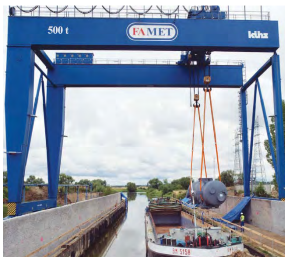
Příklad nadrozměrného výrobku v závodovém překladišti FAMET Opole
