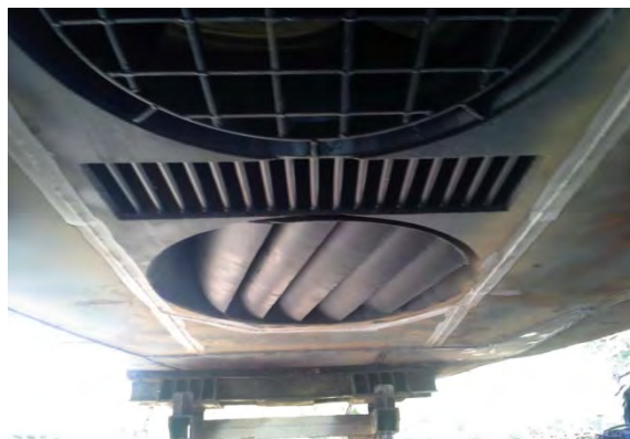
Nové dokormidlovací zařízení na lodi Silja 2
