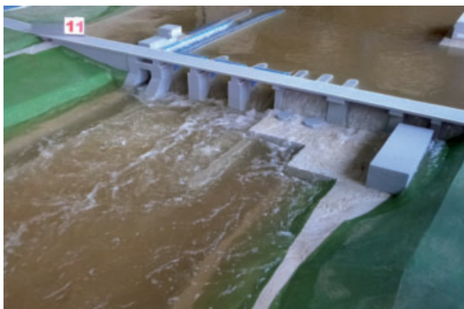
Model VD Hněvkovice 1:50, celkový pohled z levého břehu dolní vody, Q_{10000} = 2\ 600\ m^3/s
