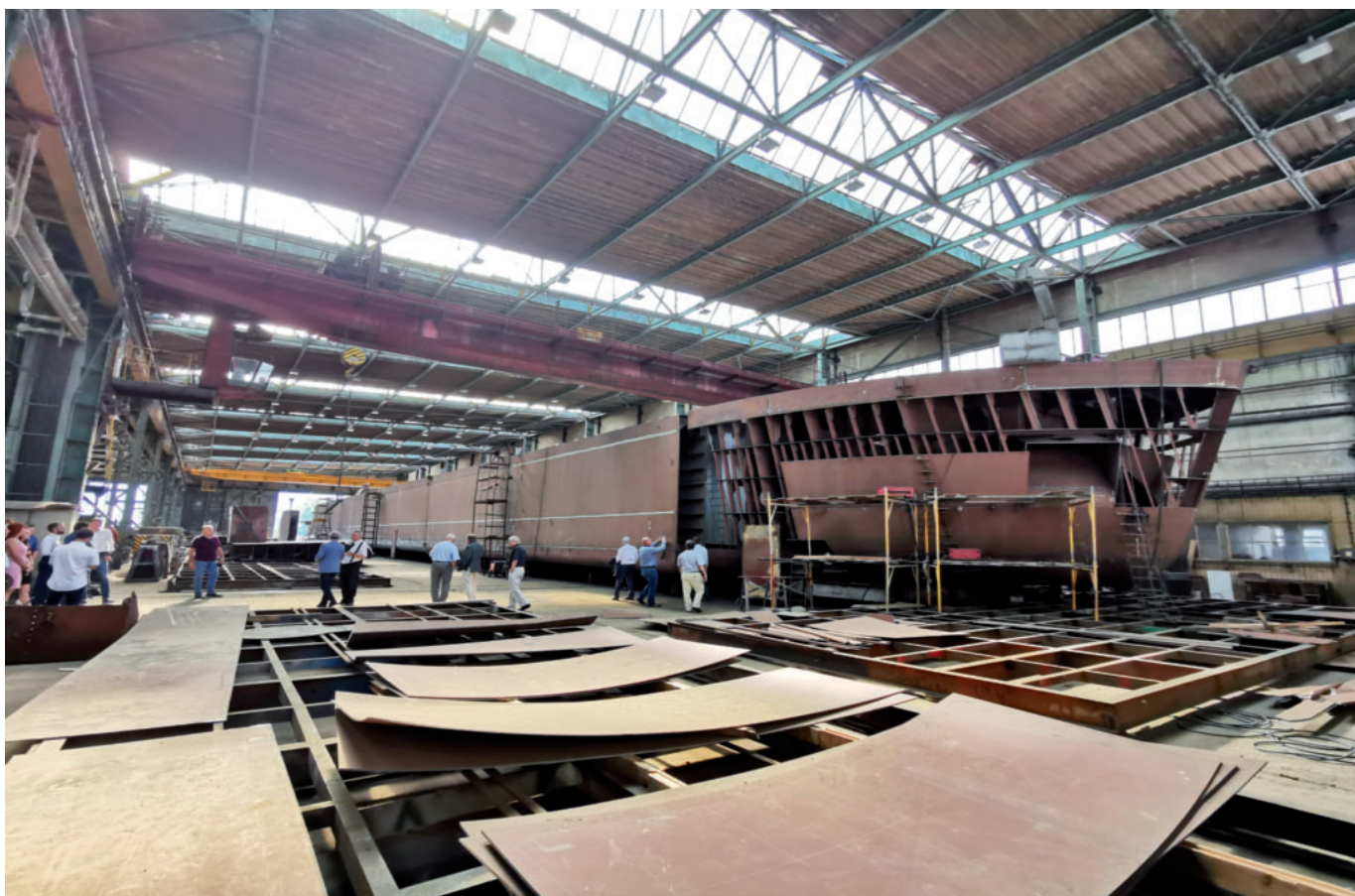
Výroba plavidel probíhá moderním způsobem v halách
