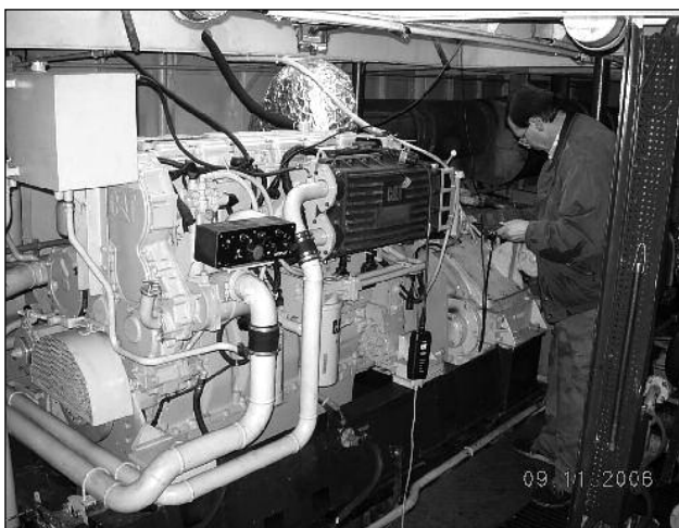
Měření emisí výfukových plynů mobilní STK nového motoru Caterpillar instalovaném v tlačném remorkéru.
