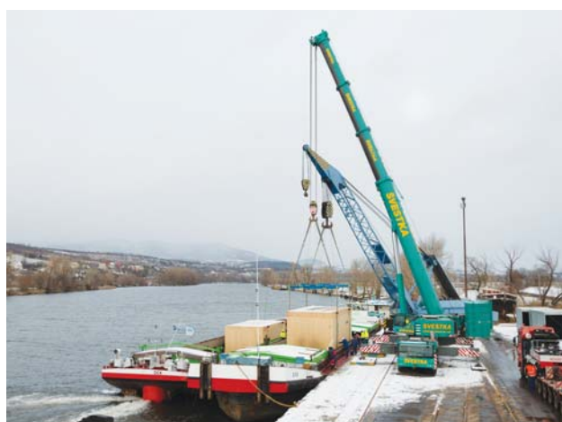
Vodní doprava je pro přepravu velkých nadrozměrných nákladů nenahraditelná. Na obr. překlád nadrozměrného nákladu GENO o váze 212 tun v přístavu Lovosice Foto: Česko-saské přístavy s.r.o.
