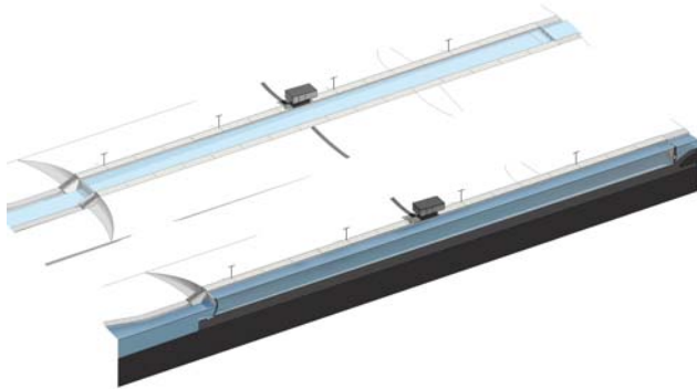
Nízká plavební komora - do 7 m rozdílu hladin
