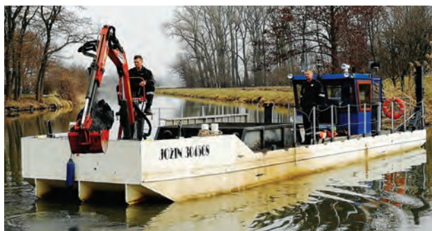
Pro údržbu Baťova kanálu slouží technické plavidlo Jožin
