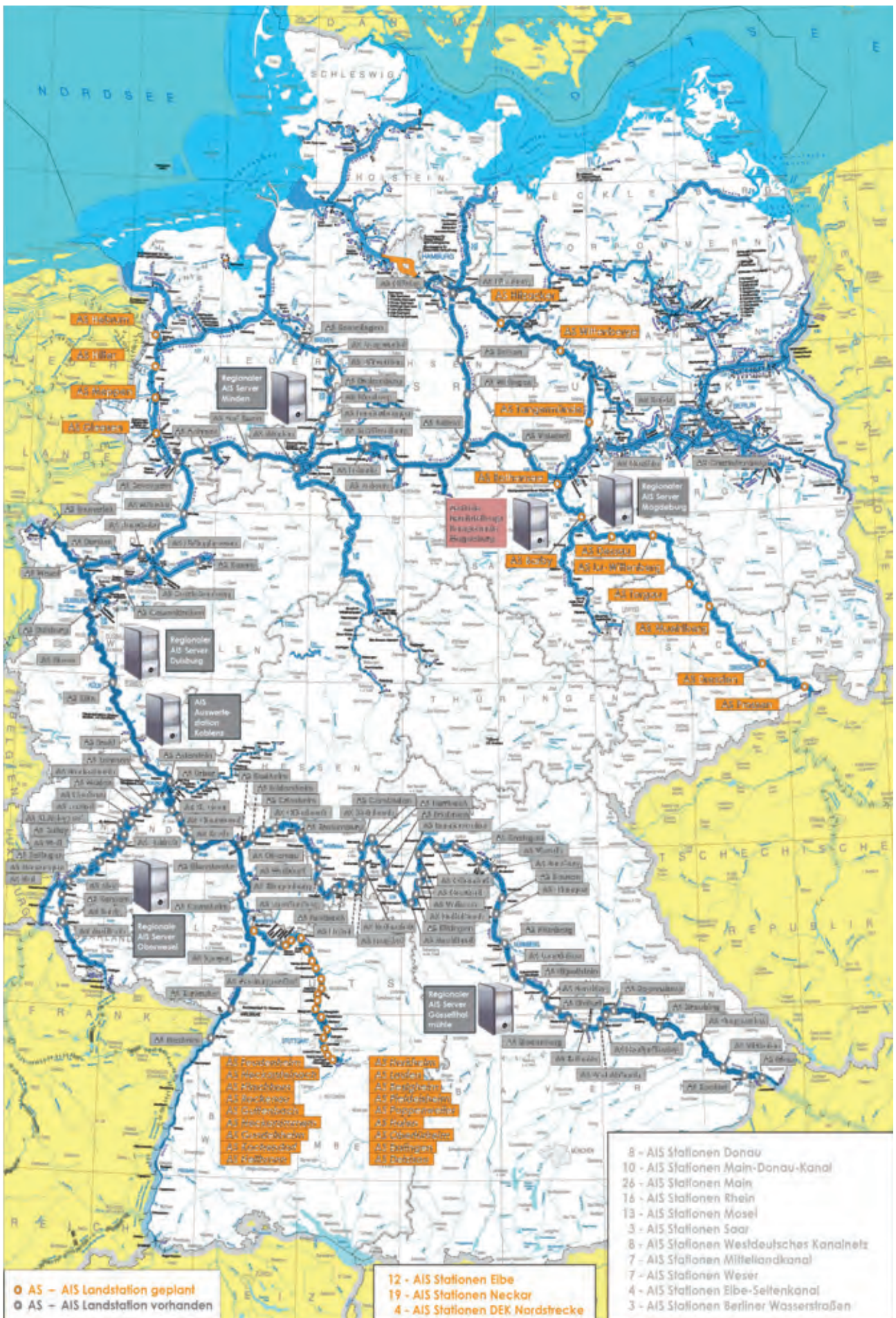
Obrázek 4: Pozemní infrastruktura AIS na vnitrozemských vodních cestách v Německu
