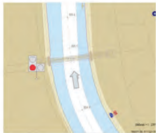
Obrázek 10: Ovládání světelných signalizačních zařízení v okresní centrále, vysílání přes AIS a zobrazování v systému ECDIS
