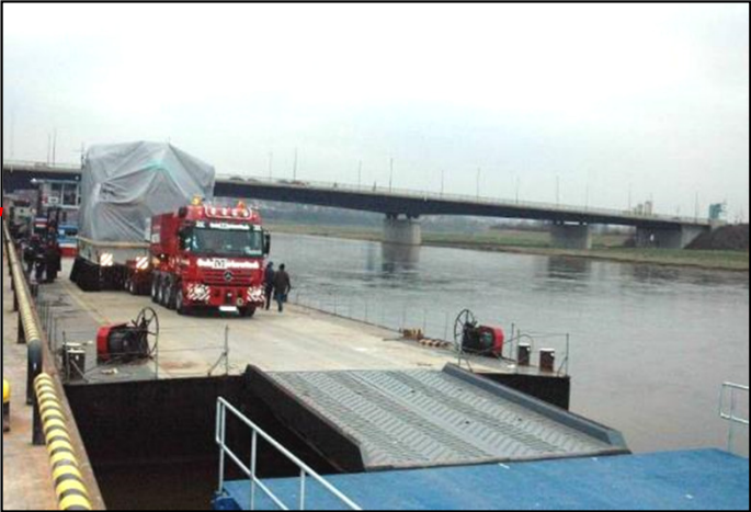
RoRo-Rampe mit Ponton
