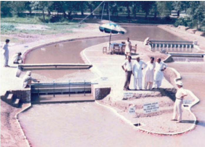
Představitelé pákistánského investora WAPDA a Ing. Jermář kontrolují ve výzkumném ústavě model projektované hydroelektrárny C-J Link na stejnojmenném kanálu, převádějícím závlahovou vodu do Indie
