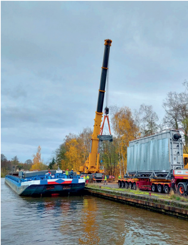
Vykládka dílů obřího lisu o hmotnosti až 150 tun, které připluly po Labi do Týnce nad Labem
