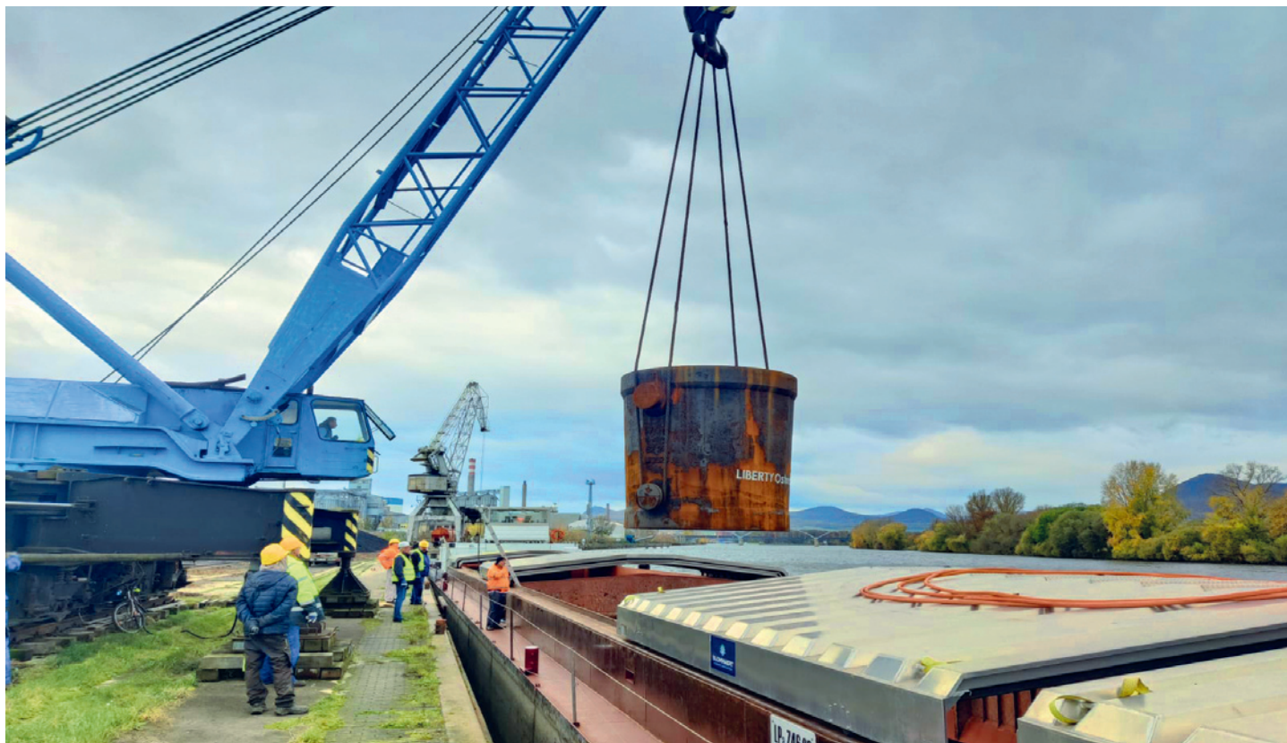
140 tun těžká slévárenská kokila zamířila z přístavu Lovosice po Labi a německých kanálech přes Rýn do Rotterdamu
