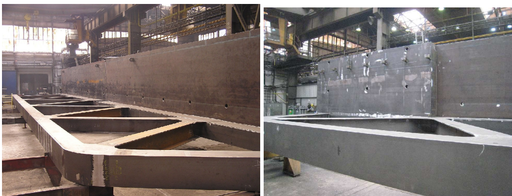
Obr.5) Výroba ocelové konstrukce, zobrazen přechod mezi štěrkovým ložem a přímým upevněním koleje.
